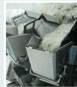
釜揚げしらすの身崩れを低減するために、材料投入後のしらすの固まりをほぐす部分の機構を改良した新たな計量充填用設備の導入を図った。具体的にはテフロン加工・エンボス加工・SUSメッシュの導入を実施。エンボス加工においては凸凹の大きさ
