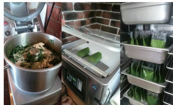
▲ロボクーブ ▲真空包装機 ▲急速冷却冷凍庫
