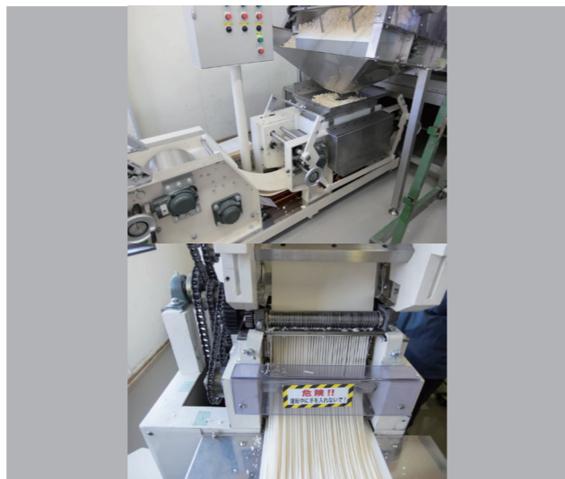
【図1】導入した「230mm製麺製造設備」
