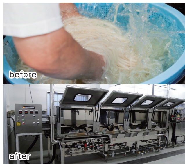
【図1】「自動反転茹で冷却槽」の導入により、従来のように熱いうどんを手洗いすることがなくなり、身体的負担が軽減した。
