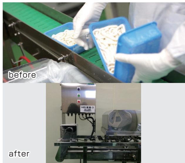
【図2】「脱パン装置(反転装置付き)」の導入により、異物混入等のリスクが軽減された。
