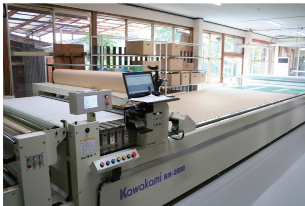
【図1】導入した裁断用CAMと連動する生地の平坦化のための延反機
