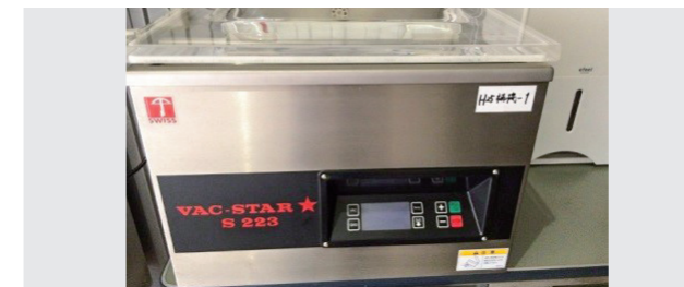
【図2】卓上型真空包装機S-223GX(ガス封入り有り)
