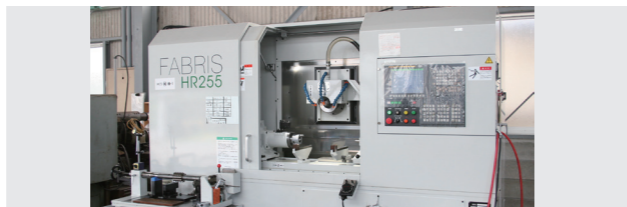
【図1】導入した新鋭CNCホブ歯溝研削盤
