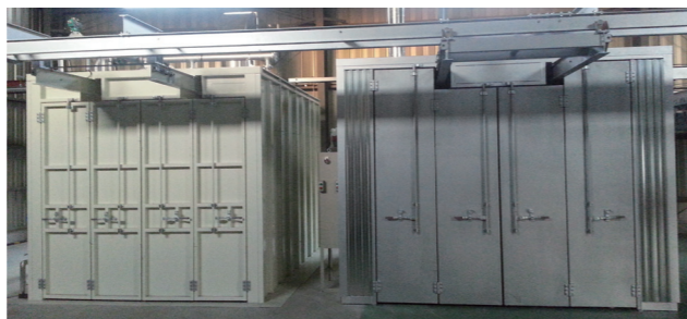
【図1】今回導入した焼付炉・搬送設備
