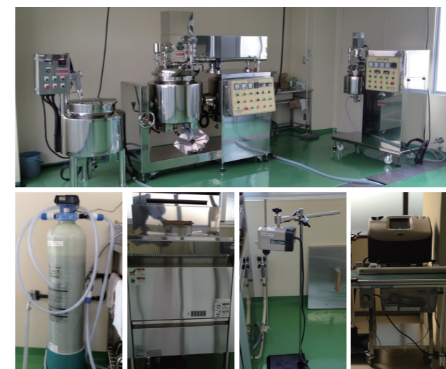
▲真空乳化装置・周辺機器設置
