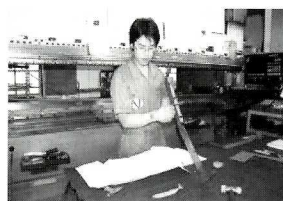
完成品を測定して、 曲げ角度を確認する喜君
